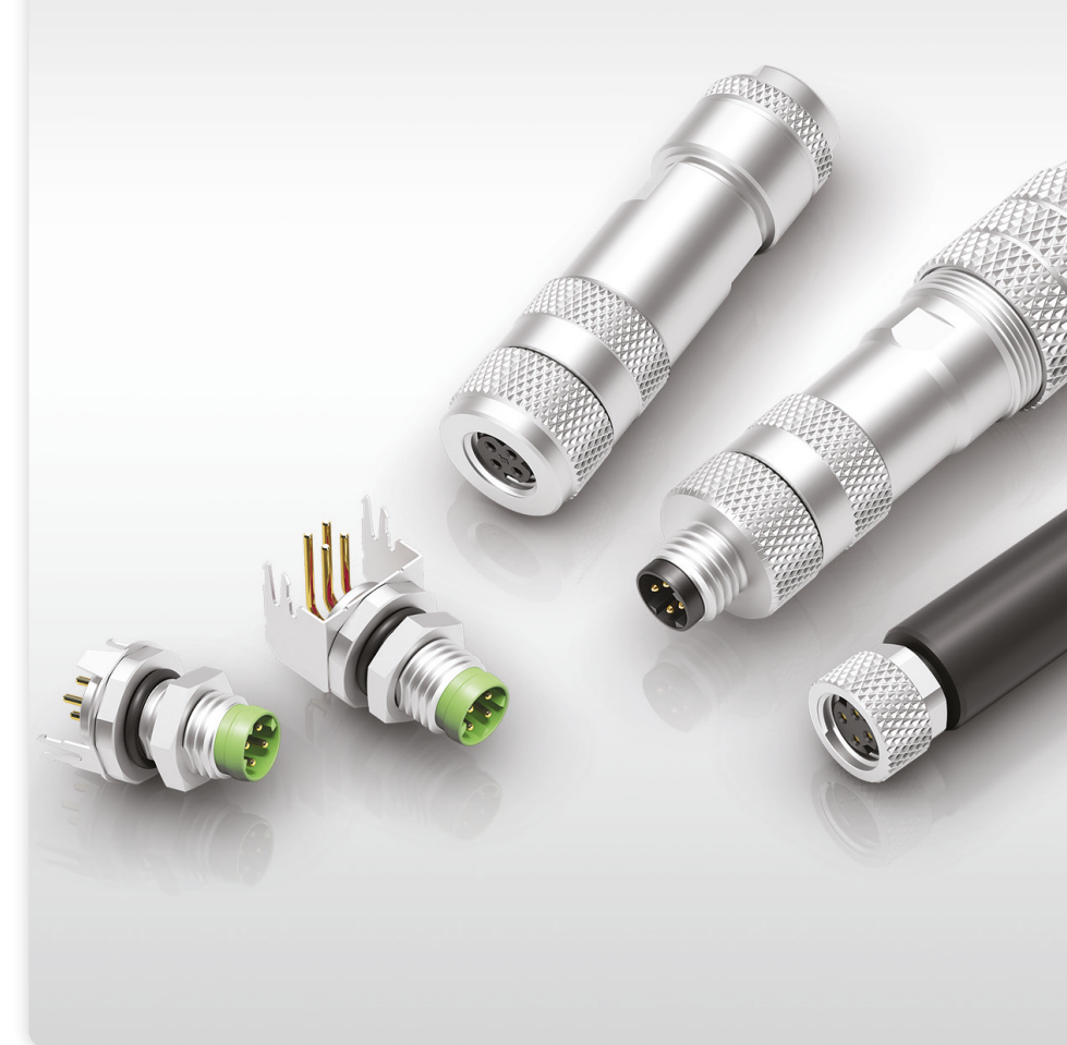
Bild 4: M8-Steckverbinder mit D-Kodierung und Schraubverschluss zur Ethernet-Anbindung einschließlich Leistungsversorgung von Industrial-IoT-Komponenten. Die Verbindung erfüllt im gesteckten, verriegelten Zustand die Vorgaben der Schutzart IP67
