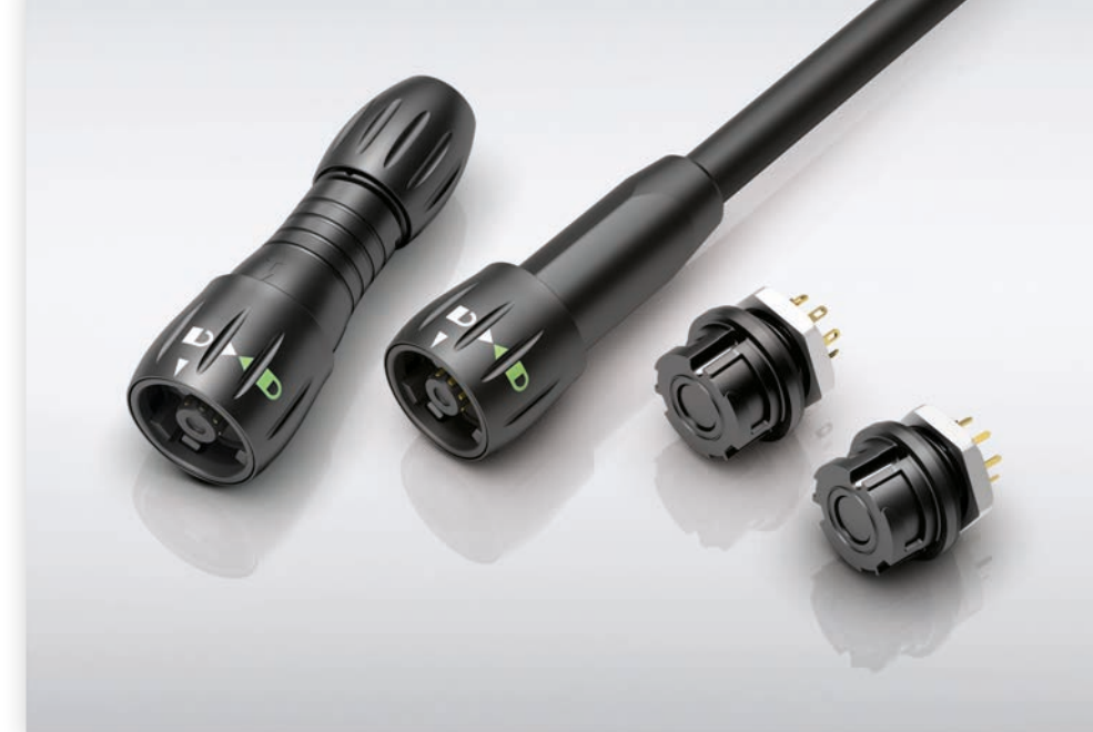
Bild 2: Not Connected Closed – die NCC-Steckverbinder der Serie 770 sind dank einer gefederten Kunststoffabdeckung auch im ungesteckten Zustand vor Partikeln und Spritzwasser geschützt
