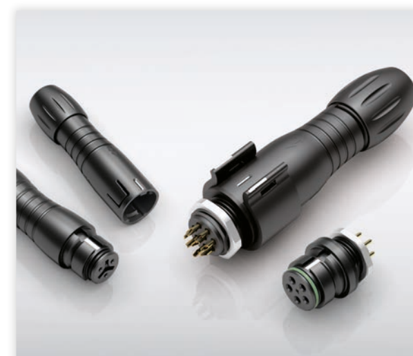
Bild 3: Miniaturisiert und nach IP67 wasserdicht: Die Serien 620 und 720 mit O-Ring an der Dosenseite und Dichtung im Klemmbereich
