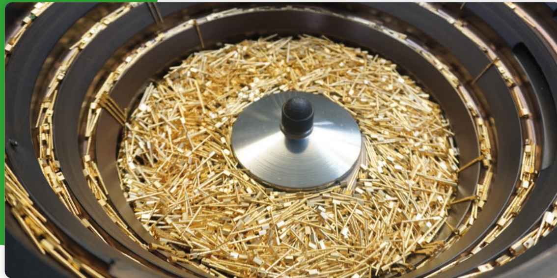
Speziell auf das Material – in diesem Fall vergoldete Kontakte – ausgelegte Fördertöpfe fördern und vereinzeln die Teile durch Vibration und Luftdruck
